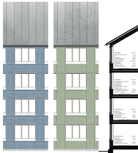
Konstruktionschnitt mit Fassadenschnitt 1:50 - Wohnhäuser
